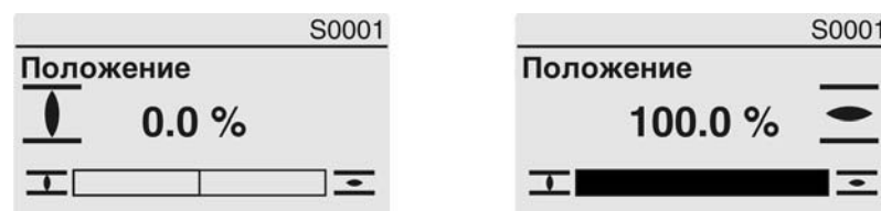
рис. 42: Достигнуто конечное положение ОТКРЫТО/ЗАКРЫТО
