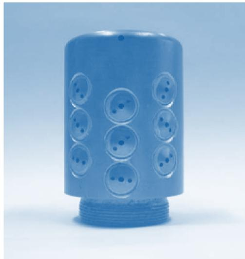
Поршень пароохладителя DS расположен за соплами и обеспечивает открытие требуемого выходного сечения. Резьбовой конец цилиндра впрыска соединяется с резьбовым концом удлинителя патрубка основного корпуса при помощи соединительного кольца, что обеспечивает различные положения между фланцем охлаждающей воды и направлением впрыска сопел.
