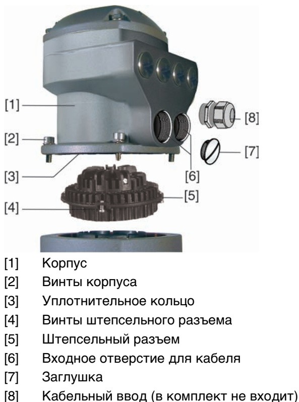
рис. 13: Сетевой штепсельный разъем AUMA SD-шины
