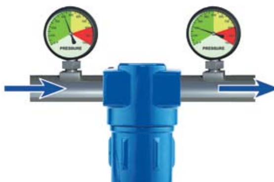
Сопротивление давлению, называемое также дифференциальным давлением (разность давления перед и за устройством)
