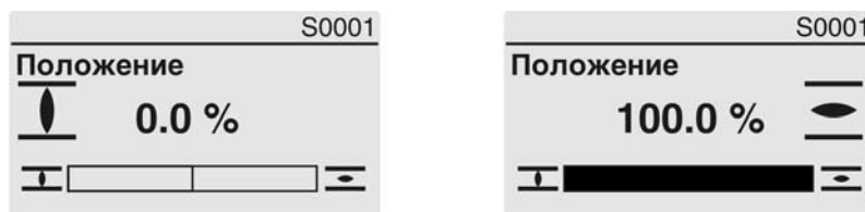
рис. 43: Достигнуто конечное положение ОТКРЫТО/ЗАКРЫТО
