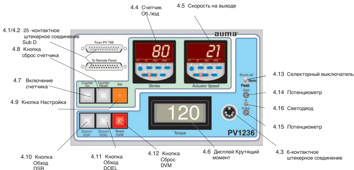
Рисунок 3 Передняя панель Измерительный модуль (Диапазон измерений до 500 Нм)
