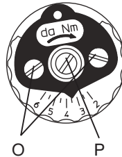
рис. L: Установочные головки регулировка ЗАКРЫТО
