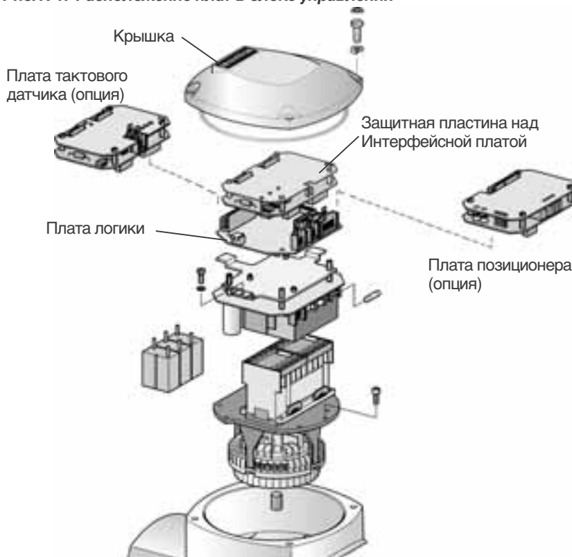
Рис. R-1: Расположение плат в блоке управления
