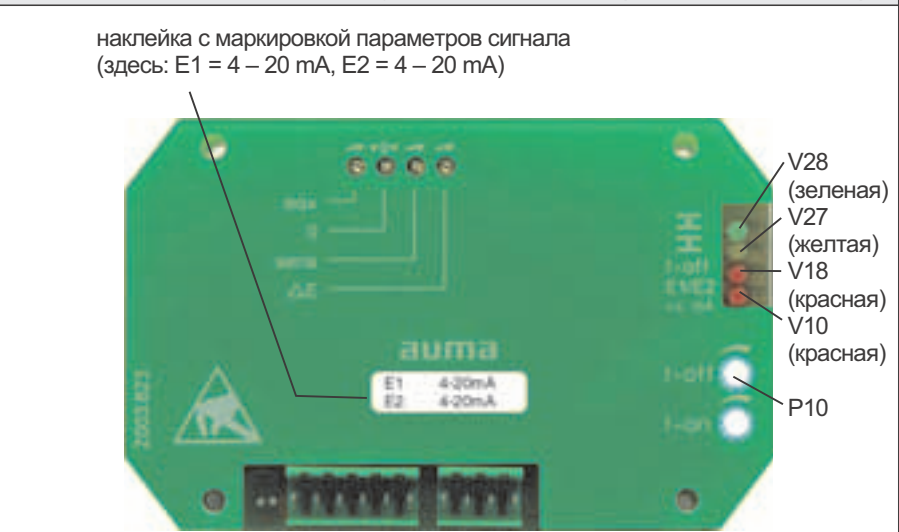
Рис. 50: защитная пластина регулятора положения (базовое исполнение)
