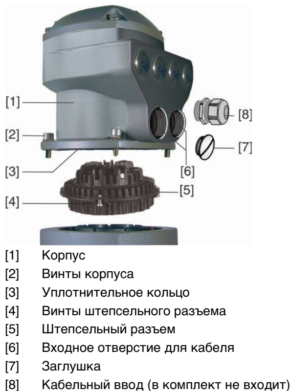
рис. 12: Сетевой штепсельный разъем AUMA SD-шины
