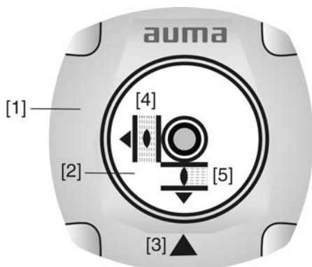
рис. 61: Механический указатель положения
