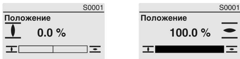
рис. 47: Достигнуто конечное положение ОТКРЫТО/ЗАКРЫТО
